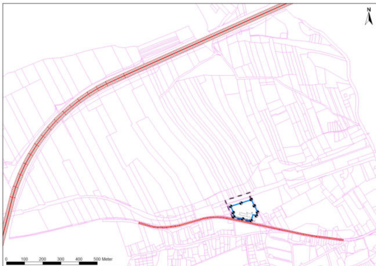
Abbildung 3: Rechenmodell-Lageplan mit Linienschallquellen für die Autobahn A9 und die Jenaer Straße
