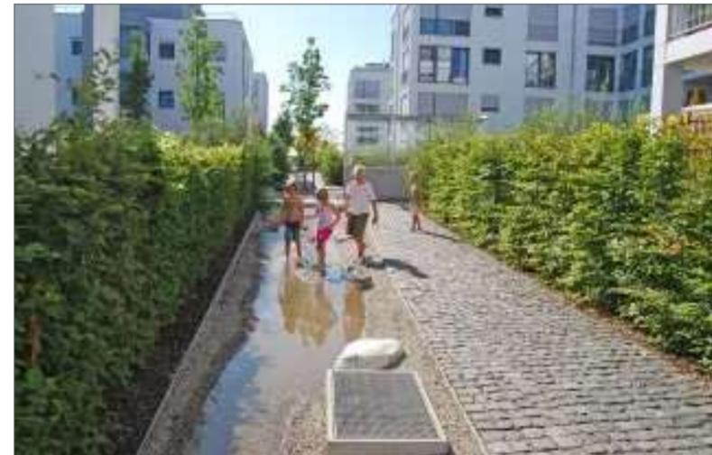
Abb. 40: Bsp.: Wasserlauf im Innenhof nimmt Niederschlagswasser auf (Zinco <https://www.zinco.de/blauer-garten-mit-regenwasserkonzept>)
